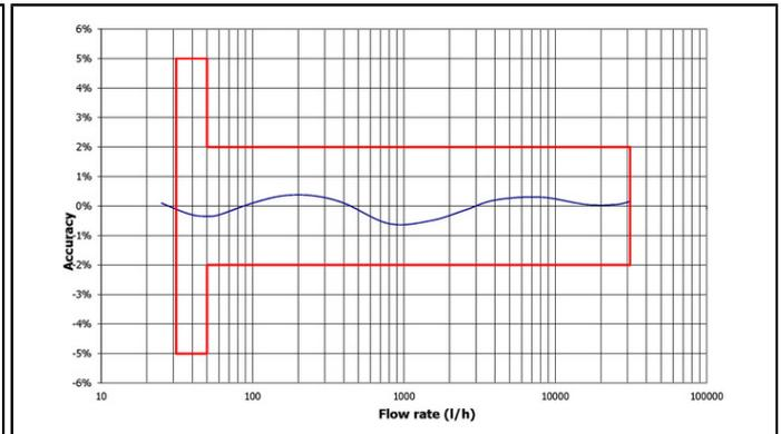
Gráfico de curva de error típica - Q<sub>3</sub> 25 m<sup>3</sup>/h
